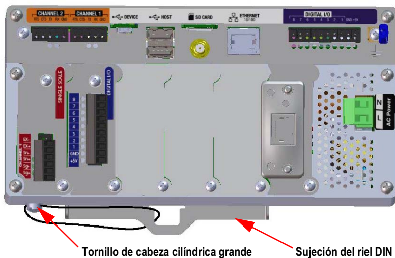
Figura 2-12. Precintado del interruptor de configuración
