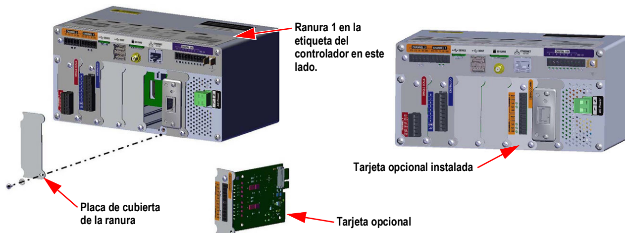
Figura 2-24. Instalación de la tarjeta opcional
