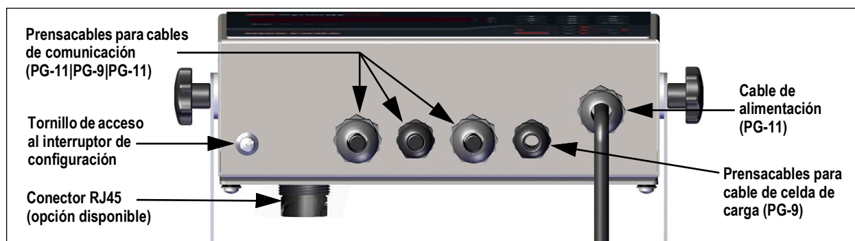
Figura 2-5. Ubicaciones recomendadas para los prensacables
